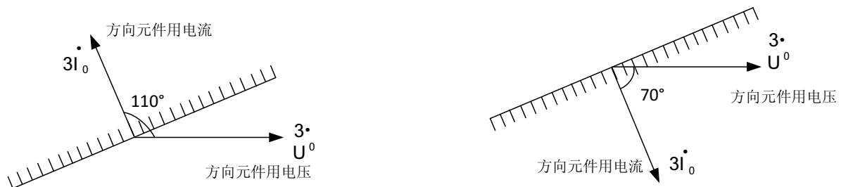
(a) 方向指向变压器时的动作区(阴影侧) (b) 方向指向母线时的动作区(阴影侧)
